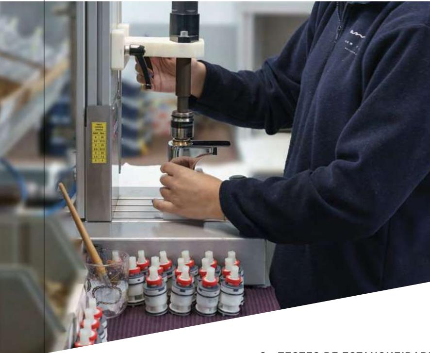
6 - TESTES DE ESTANQUEIDADE | TIGHTNESS TESTS |
